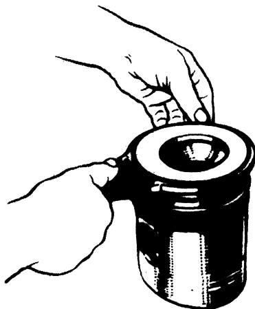
Рис. 78. Снятие и надевание поршневых колец
